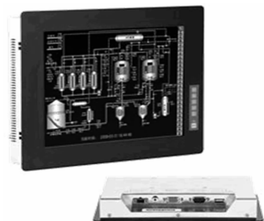
图 1.5 面板式工业控制机
