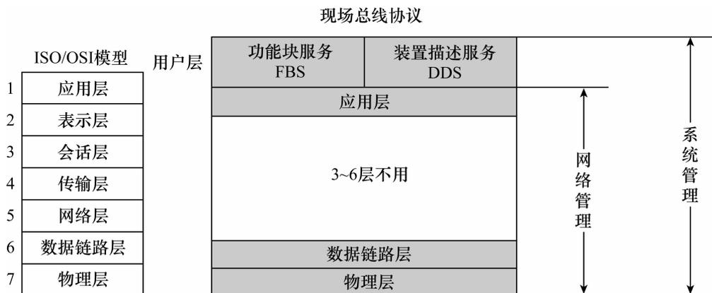
图 2-5 IEC61158 现场总线通信协议模型
